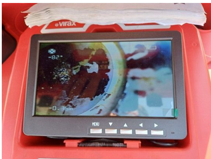
08- Contrôle visuelle par caméra EP
