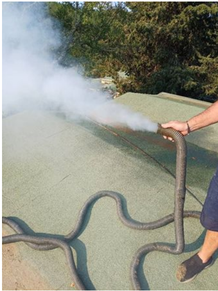
05- Contrôle de l'étanchéité par test fumigène
