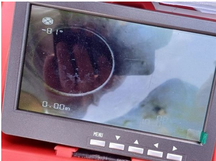
08- Contrôle visuelle par caméra EP
