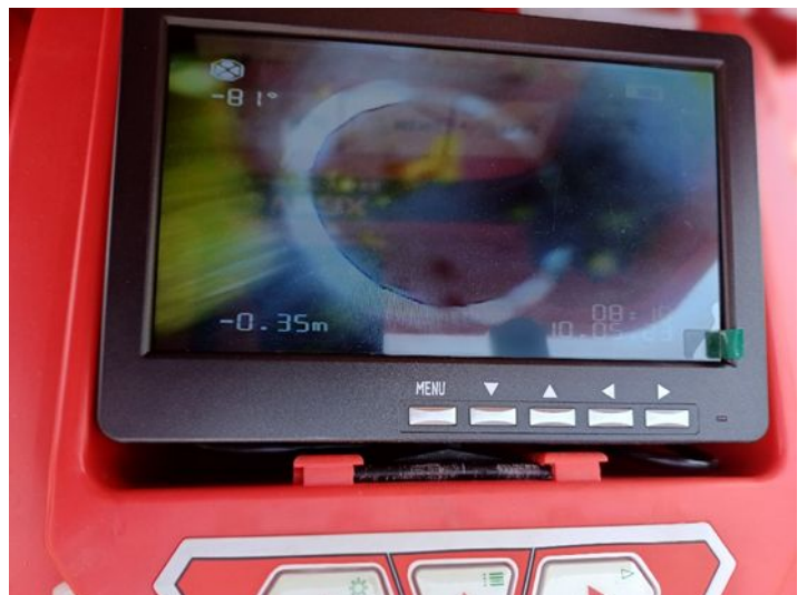
08- Contrôle visuelle par caméra EP
