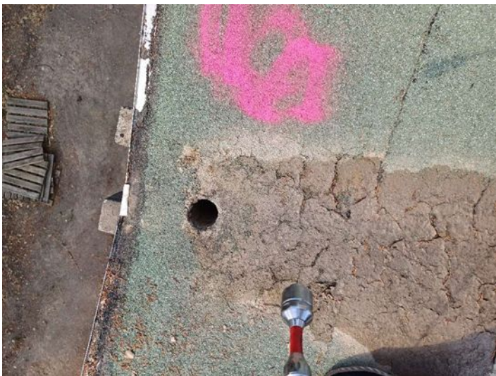
08- Contrôle visuelle par caméra EP
