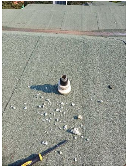
05- Contrôle de l'étanchéité par test fumigène
